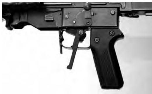
Figura 17: Grilletto ausiliario d'inverno per F ass 57
