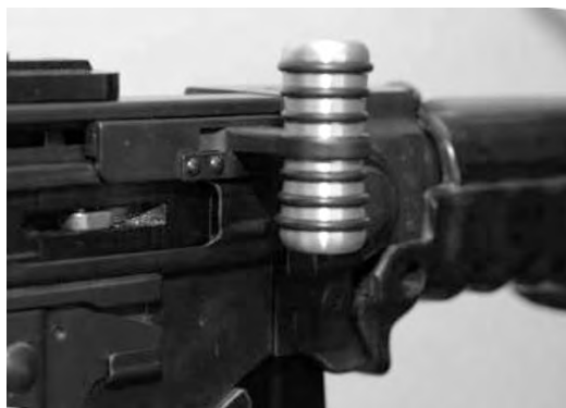
Figura 18: Leva d'armamento anatomica per F ass 57
