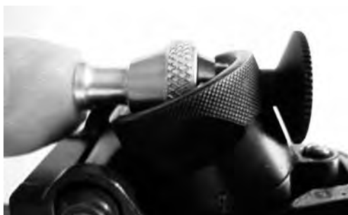
Figura 5: Sistema di filtri colorati Wyss innestabile
