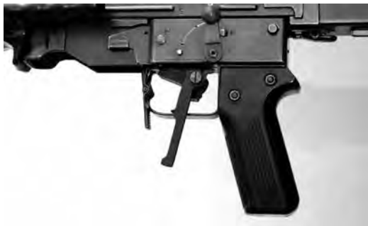
Bild 17: Winterabzug für Linksschützen zu Stgw 57
