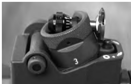
Figura 3: Diaframma ad iride per F ass 90 (con o senza filtri), diversi modelli
