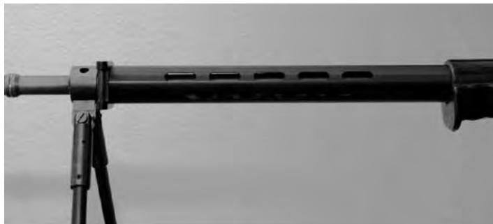
Bild 16: Mantelrohr zu Stgw 57
