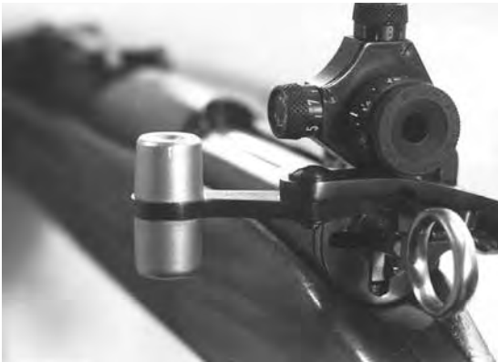
Bild 21: Linksriegel zu Karabiner 31
